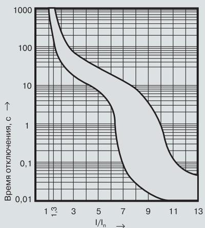
**Выключатели с электромагнитным расцепителем тока с гидравлическим замедлением срабатывания при температуре окружающей среды (25±10)°С в холодном состоянии.**
